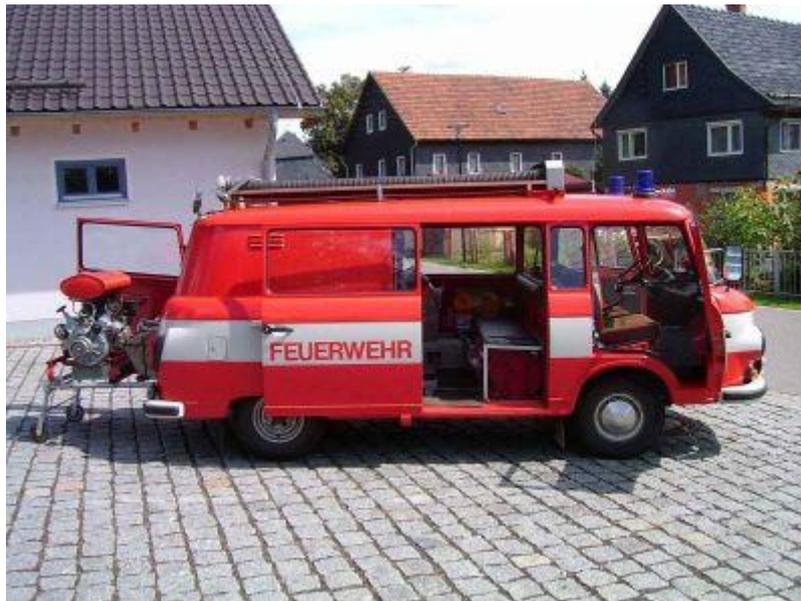
Im Aufbau befinden sich die Sitze für den Trupp, Gerätekästen und zur besseren Entnahme der schweren Geräte, ein nach hinten ausziehbarer Geräteschlitten. Der Geräteschlitten ist auf einen ausziehbaren Rollrahmenfahrgestell gelagert. Dieser hatte an einer Seite zwei schwenkbare Räder und auf der anderen Seite zwei Rollen die in U-Profileschienen laufen. Auf dem Gestell ist quer stehend hinten eine
