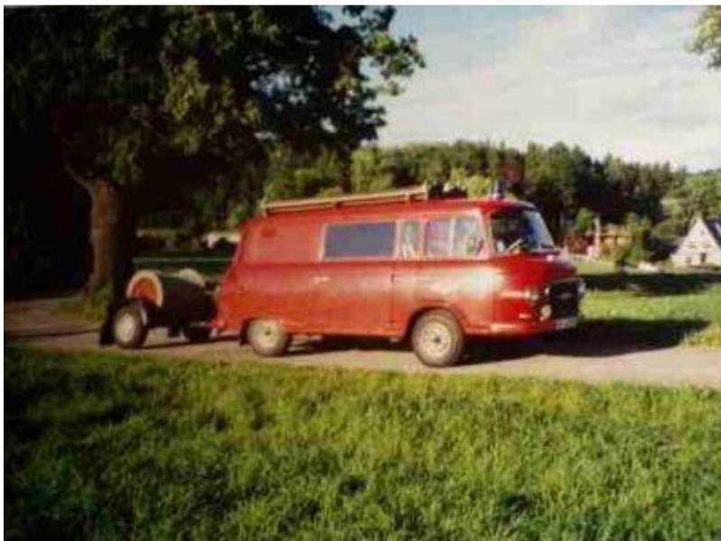
Kurz darauf wurde allerdings die Halbbus Variante mit Fenster am Aufbau verwendet. Zusätzlich bekamen die Fahrzeuge zur besseren Verkehrssicherheit zwei Blaulicht - Rundumkennleuchten und eine Sirene aufgesetzt. In den späteren Baujahren wurde die seitliche Klapptür durch eine Schiebetür ersetzt.
