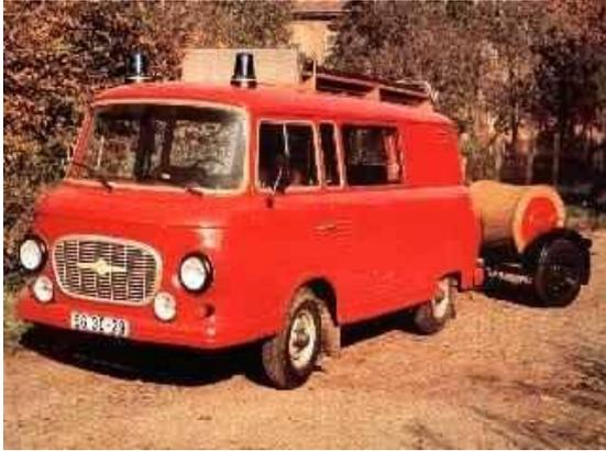
Die fahrbare Schlauchhaspel HF-B1000 dient zum Transport von 160m B-Druckschläuchen. Sie ist speziell für das KLF TS8 auf B1000 gebaut. Da das Auslegen nur im handzugbetrieb erlaubt ist, wurde die Schlauchhaspel mit einer Seilzugbremse versehen.
