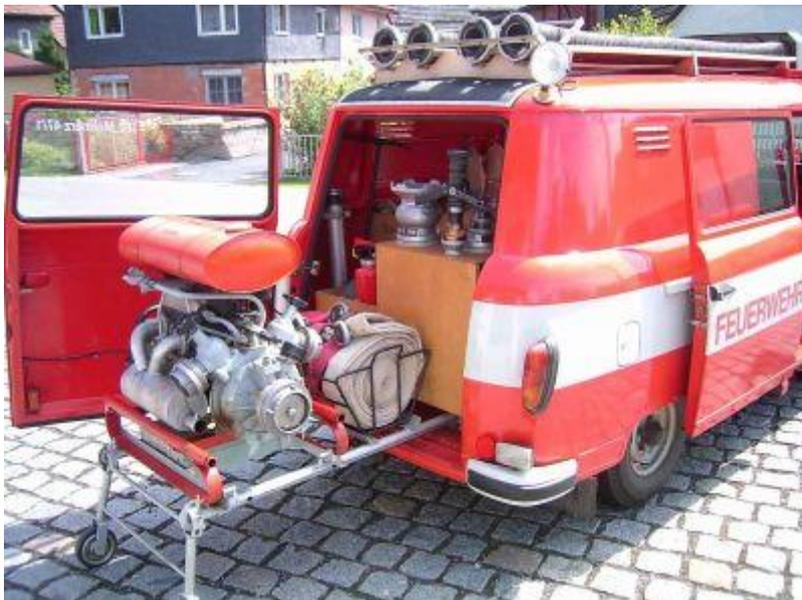
Die auf dem Gestell quer stehende Tragkraftspritze 8 und die tragbare C-Schlauchhaspel werden durch Schnappriegel gesichert. Daneben sind Gerätekisten in Schienen eingeschoben und verriegelt. Das Standrohr und die Schlüssel für den Unter- und den Überflurhydranten lassen sich, unabhängig davon,
