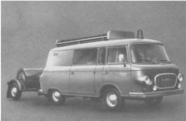
Das Fahrzeug ist ein serienmäßig gefertigter, vollkommen geschlossener Kastenwagen vom Typ Barkas B 1000. Der Aufbau hat hinten sowie an der rechten Seite Einstiegstüren. Zur Beheizung ist im Kofferaufbau eine Benzinheizung installiert.
